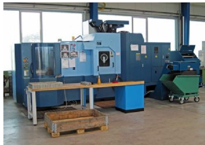
Blick in die Fertigung: Vertikal-Bearbeitungszentrum für 5-Achsen-Bearbeitung.
