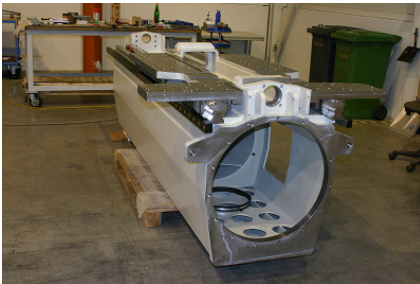
Lineareinheit (Blech-Schweißkonstruktion) inkl. kompletter mechanischer Bearbeitung Genauigkeit bis 0,02 mm.
